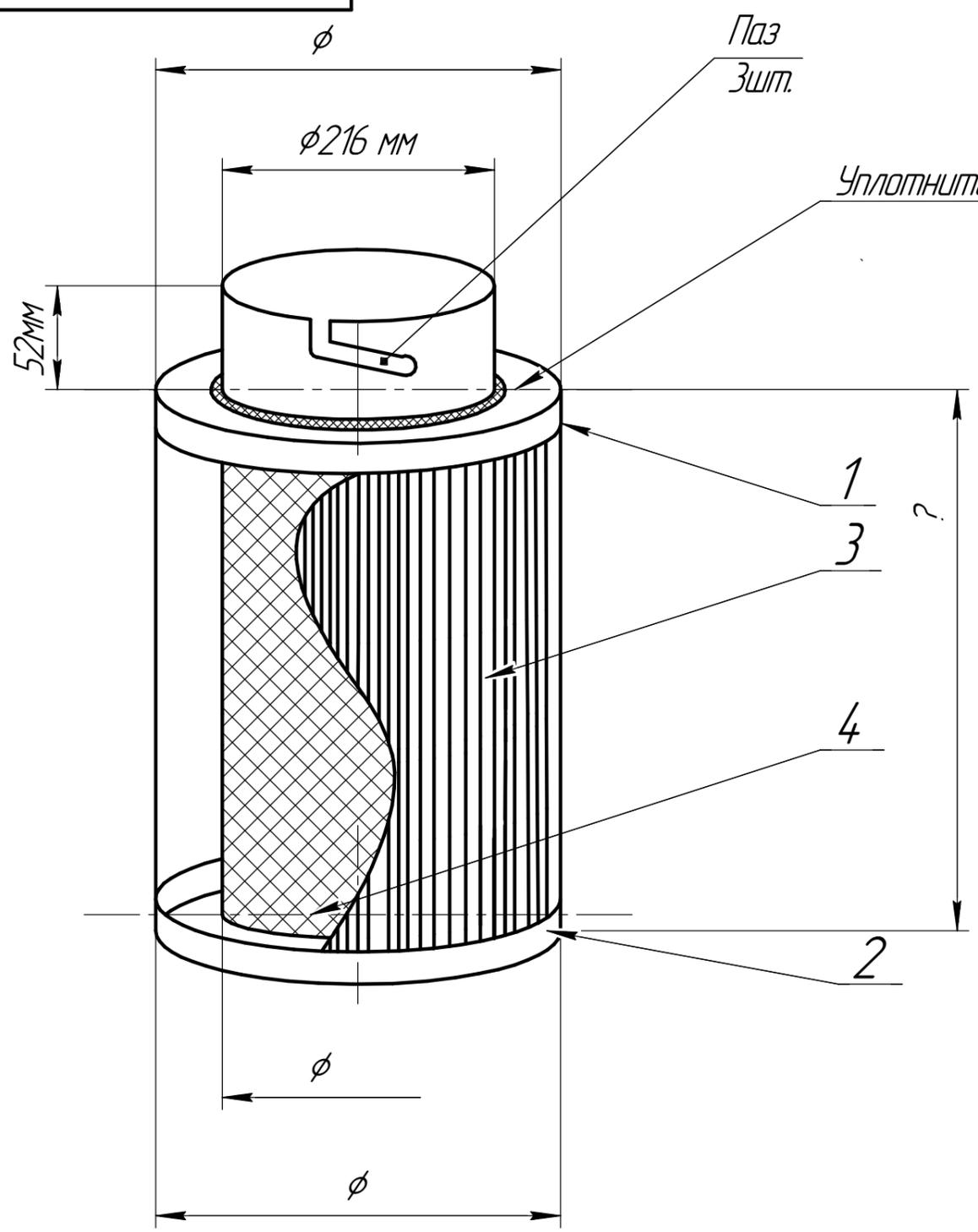
Уплотнитель Гернит Ф15мм
